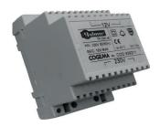
Transformador de alimentación para equipos de portero electrónico, con instalación 4+n'. Salida de **12Vc.a.** con alimentación a 230Vc.a. / 18Vc.a. (DIN 3).
