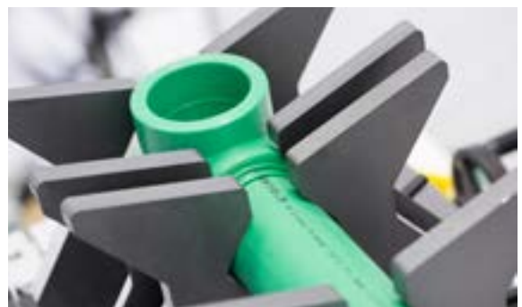
Introducir el tubo en el accesorio
