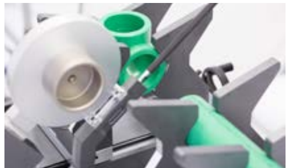
Aplicar las matrices en tubos y accesorios
