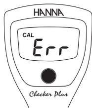
Debemos limpiar la sonda si en el modo de calibración, el medidor muestra el mensaje "Err", y este está en la solución correcta de tampón. Introduzca la sonda en la solución de limpieza HI700601 durante 15 minutos. Enjuague con agua destilada y colóquela en una solución de almacenamiento durante 1 hora antes de calibrar. Si el mensaje "Err" persiste, se debe reemplazar la sonda HI1271.
