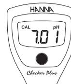
Si parpadea en pantalla la numeración "7.01", introduzca la punta de la sonda en una solución tampón de pH 4, 7, o 10 según corresponda.
