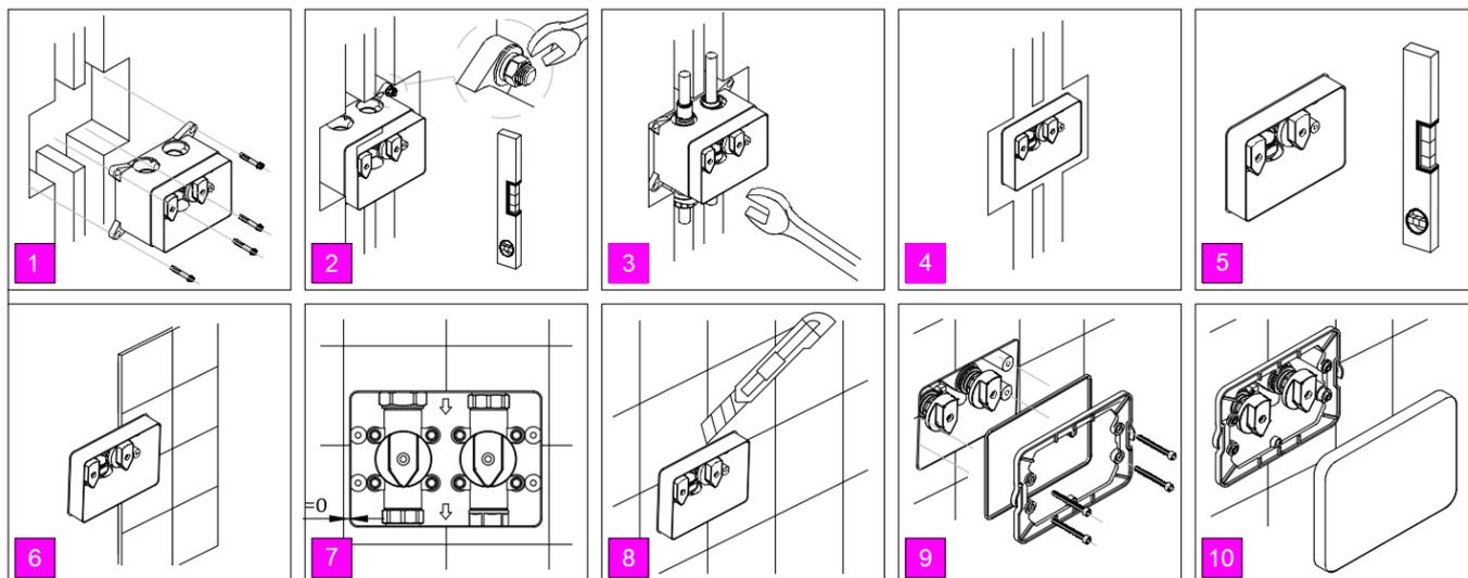
**1. Colocar los 4 tornillos expansión (12) en la pared, con la caja (1) como referencia.**
