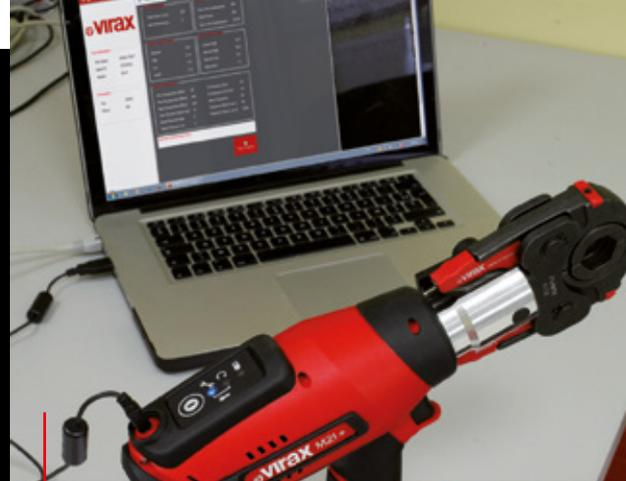
**Conectada**, informa de su estado (batería, temperatura,...) y avisa del mantenimiento.
