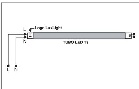
Esquema montaje con balasto magnético.
