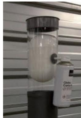
En ese momento se procederá a la reparación o sustitución del bajante o colector. Una vez concluida la reparación, se estira de la sonda que es retráctil y perforada y el Globo se desinfla totalmente.
