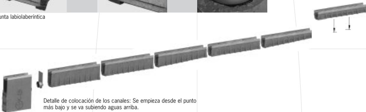
Detalle de colocación de los canales: Se empieza desde el punto más bajo y se va subiendo aguas arriba.
